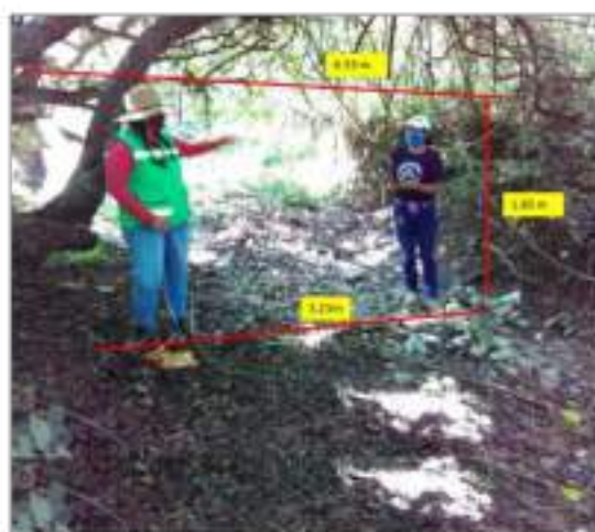
Fotografía 8. En el punto 1 encontramos el cauce natural y registramos sus medidas, parte superior del cauce 6.55 m, base 3.2 m, altura 1.85 m.
