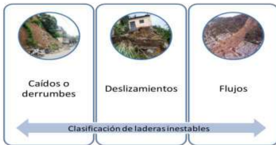
Figura 4. Clasificación de los tipos de ladera inestable estudiados en este trabajo (Modificado de CENAPRED, 2011).
